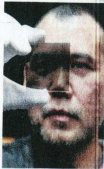
CERMIN gelap yang digunakan bagi menentukan bacaan penyukat cahaya.
